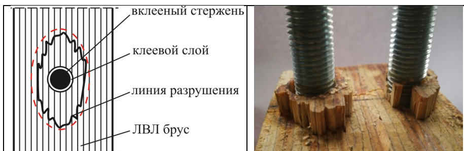
Рис. 3 Схема разрушения клееных стержней
