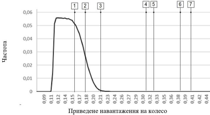
Рис. 1 – Полігон вертикальних навантажень на колесо
