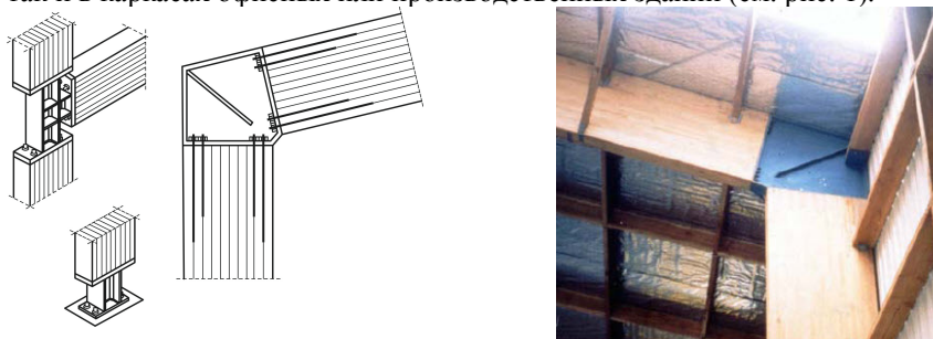
Рис. 1 Соединения на клеенных стержнях с металлической вставкой
